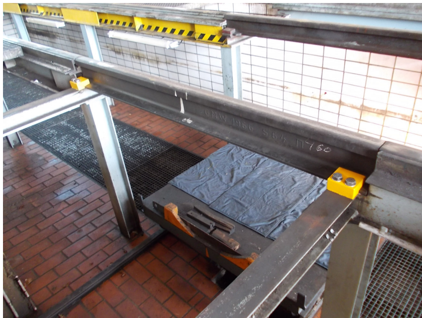
Abbildung 1: Verschraubte Sicherungsklötze an der Achssenke
