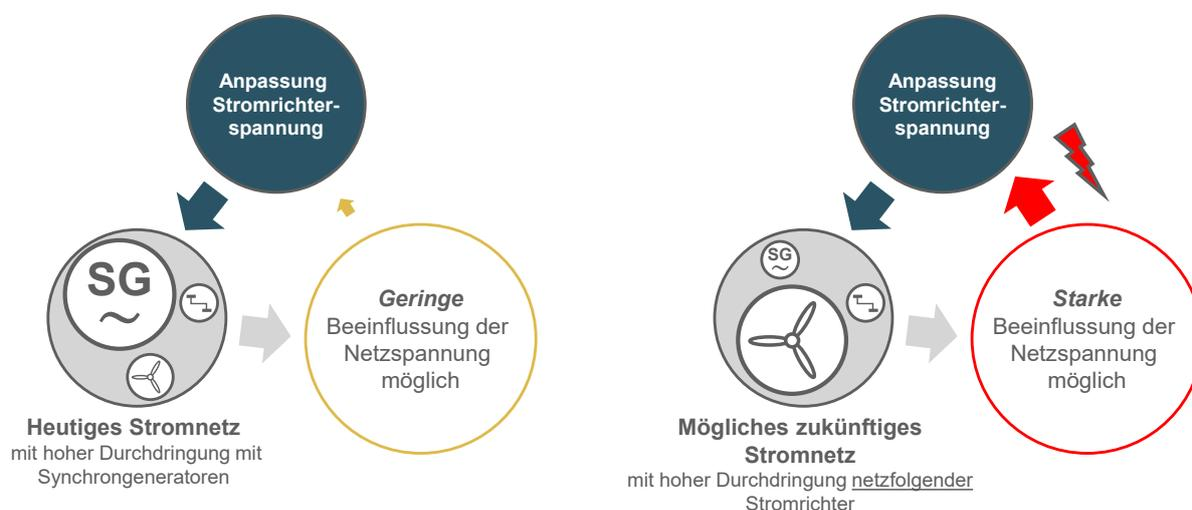
Abbildung 6: Überblick des Wirkzusammenhangs der Stromrichterspannung und Netzspannung bei unterschiedlichen Durchdringungen von netzfolgenden bzw. netzbildenden Anlagen
