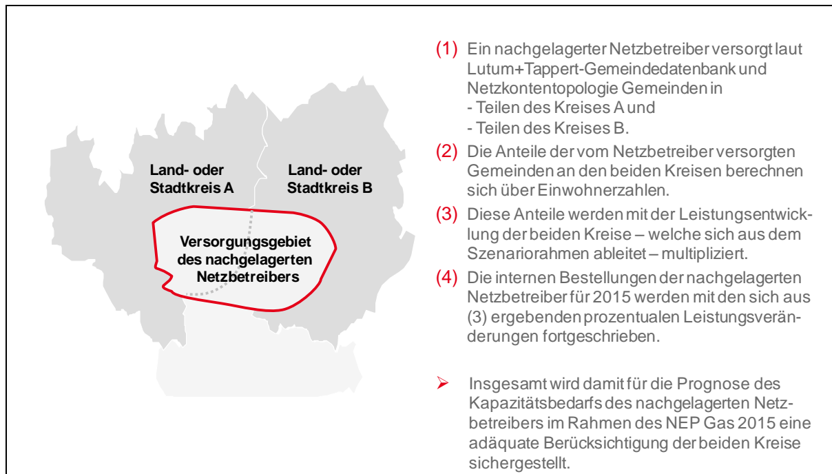
Abbildung 7: Weiterverarbeitung der Daten am Beispiel eines nachgelagerten Netzbetreibers
