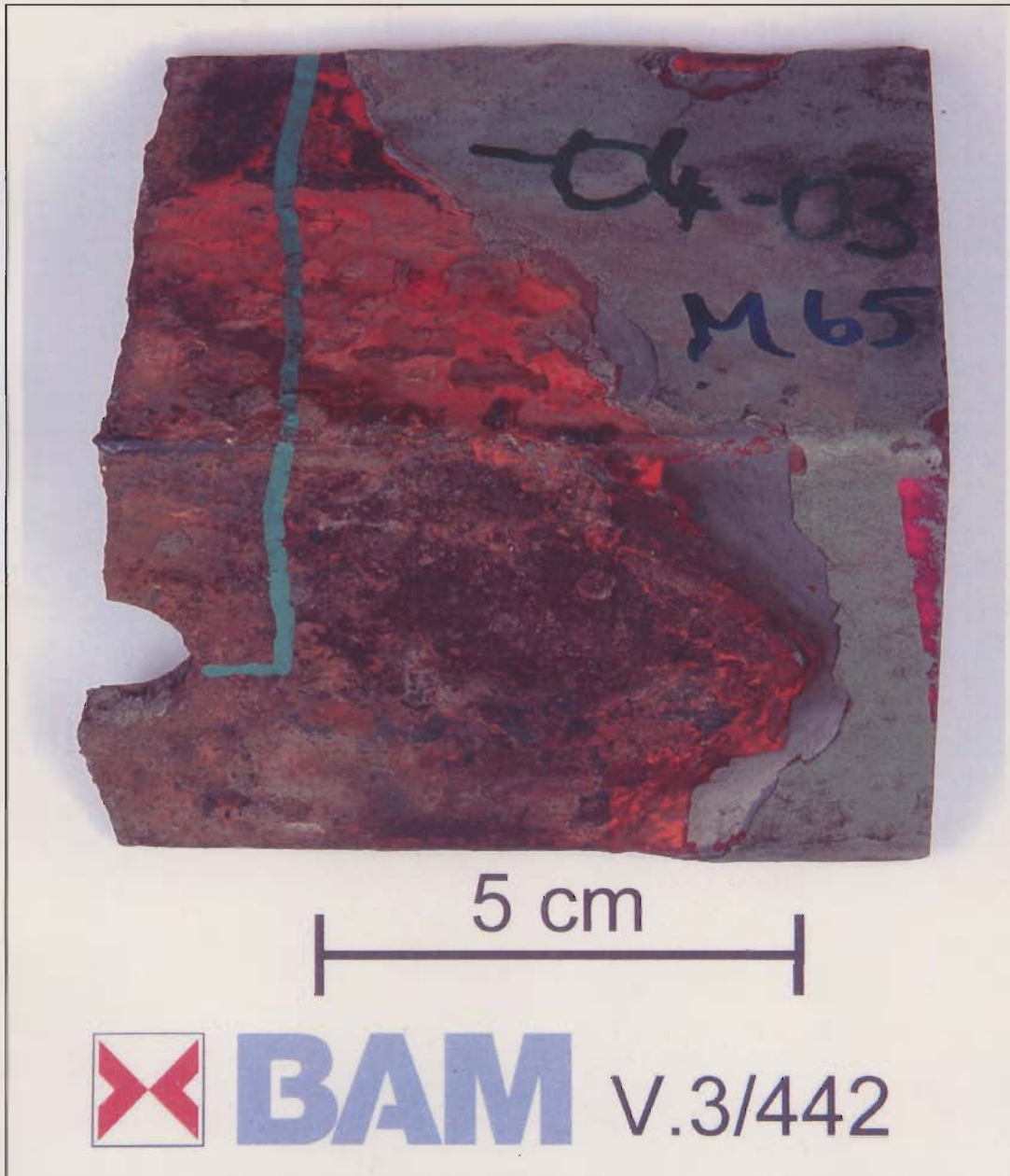
Bild 58: 1503-M65-04-03 (1960), Diagonale, St 37.12. Bruchfläche an einem Loch (links im Bild). Digitalkamera.
