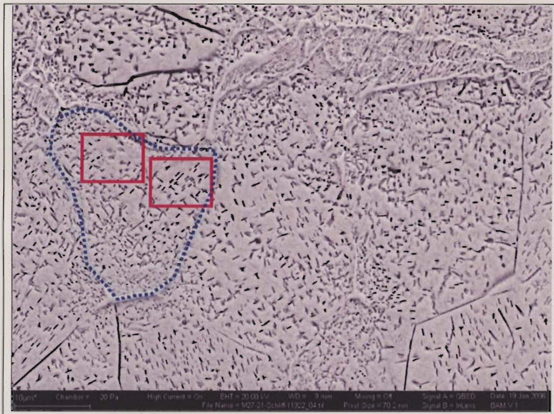
Bild 89: Vergrößerung aus Bild 86, ungefähr gleiche Vergrößerung wie die beiden vorigen Bilder, aber REM-Aufnahme. Randbereich. Ferrit-Körner mit Nitrid-Ausscheidungen. Die blaue Linie markiert ein Ferrit-Korn, dessen (001)-Achse senkrecht zur Bildebene steht. Ätzung nach Fry. REM.
