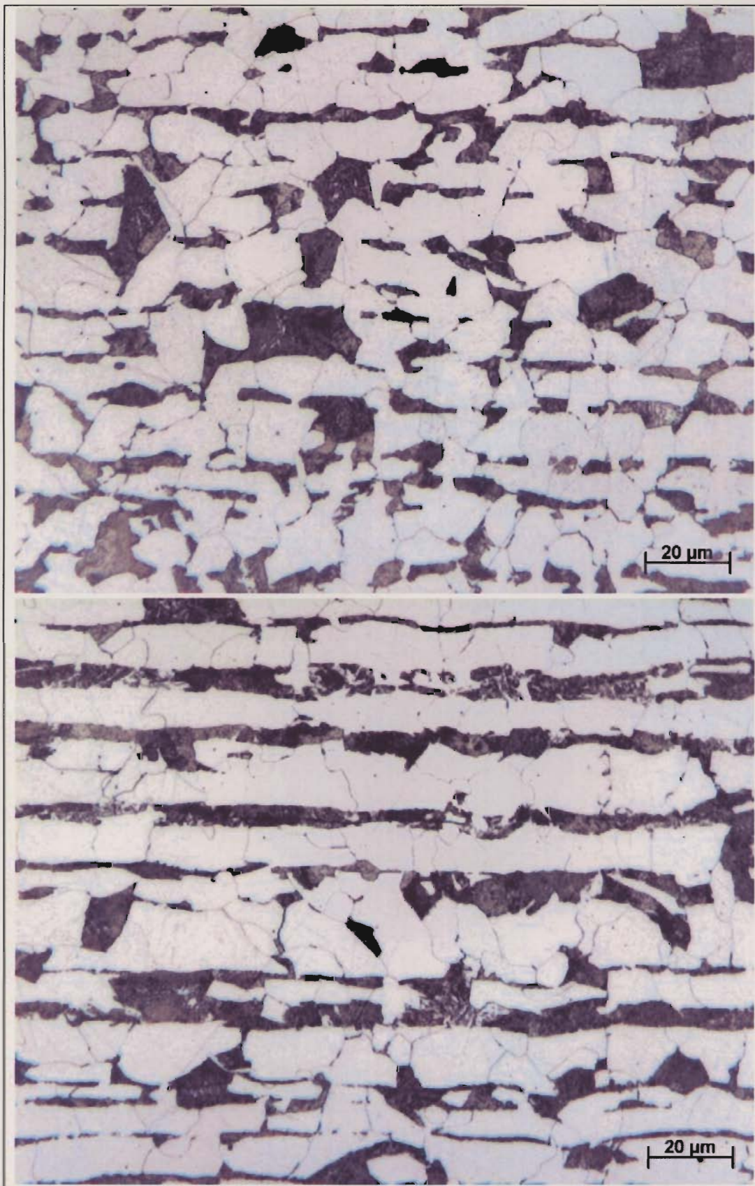
Bild 83: 1503-M73-13-01 (1960), Diagonale, St 52-3, Grundgefüge, Längsschliff, Nitral. Lichtmikroskop. Oben Randbereich, unten Mittelbereich.
