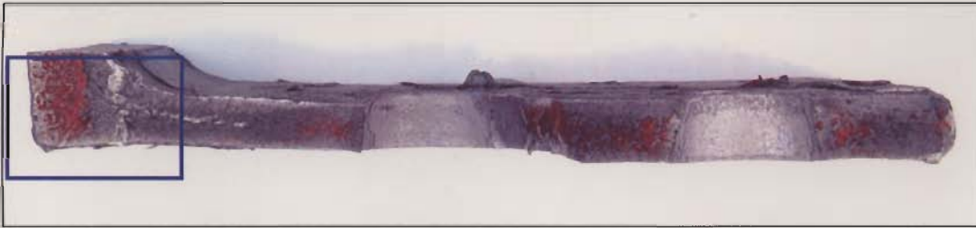
Bild 71: 1525-M22- B14 und B15 (1991), Eckstiel, St 52. Bruchfläche des Teilstücks in Bild 70 rechts unten, mit Zitronensäure gereinigt. Digitalkamera.
