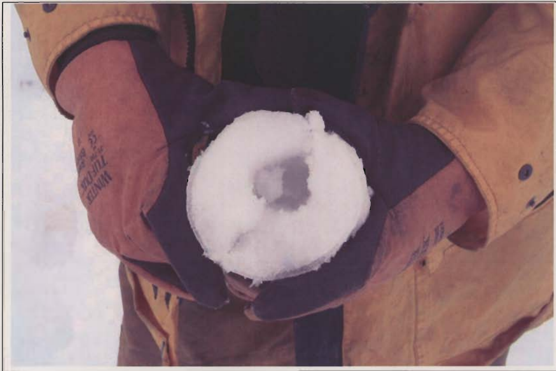
Bild 116: IMG_7995: Abgeschlagene Schneewalze, BL1503 Gronau – Coesfeld (110 kV), östlich von Legden, 28.11.2005, Foto M. Stehr, [64].
